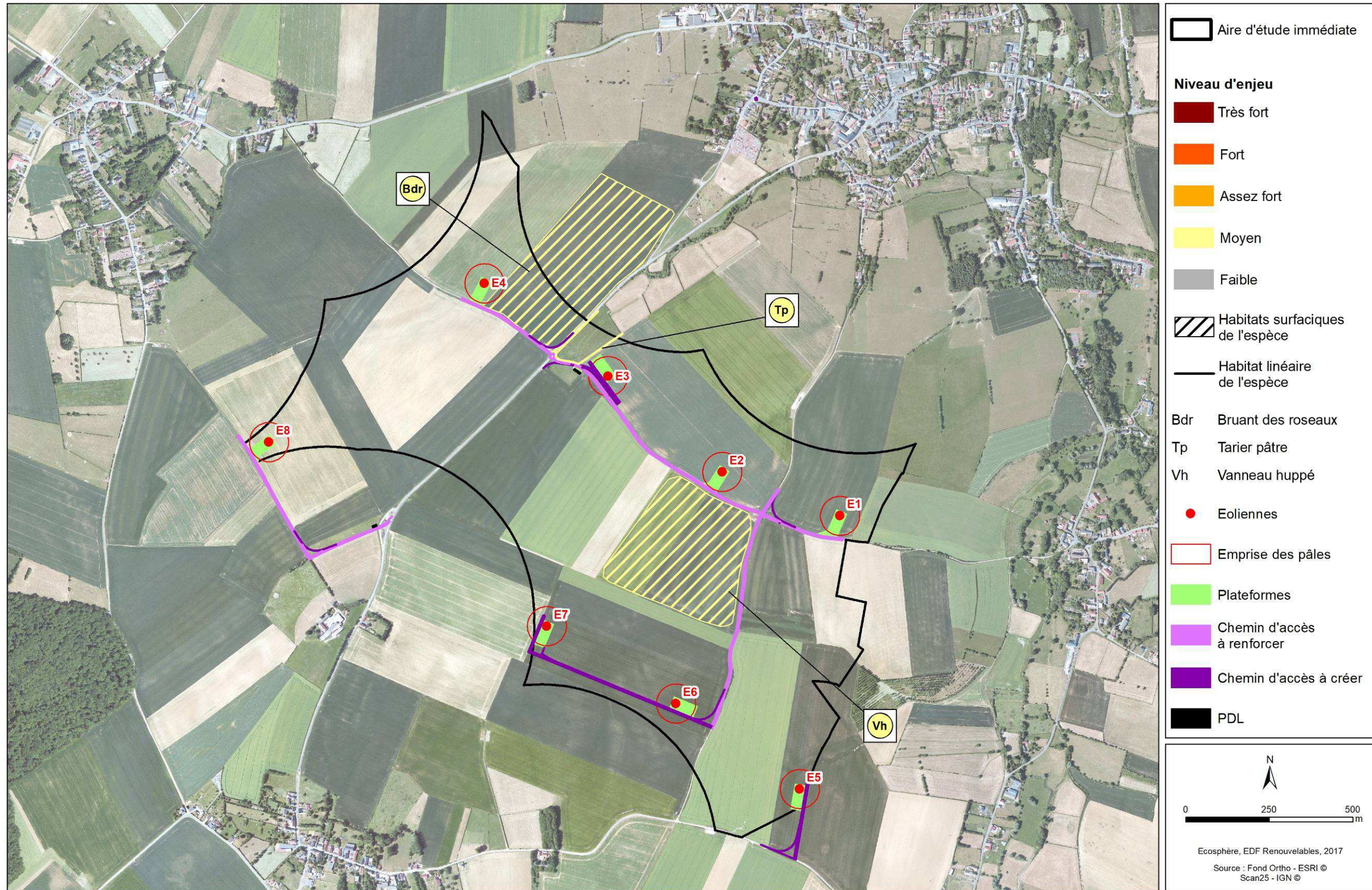
Carte 29 : Disposition du parc éolien par rapport aux espèces d'oiseaux d'enjeu recensées en 2016
