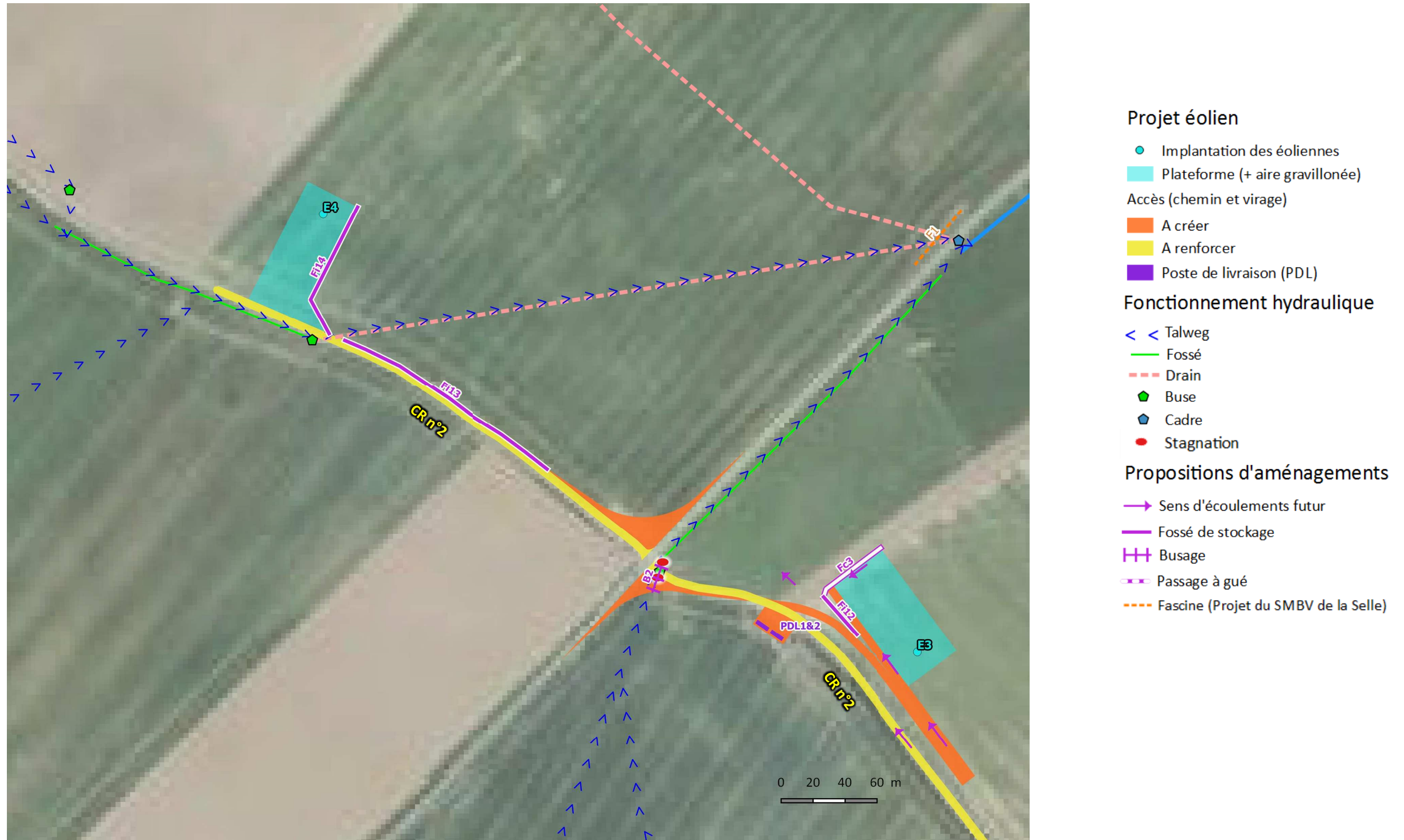
Schéma 20 : Aménagements de gestion des eaux pluviales aux abords d'E4, d'E3 et des chemins ruraux n°2
